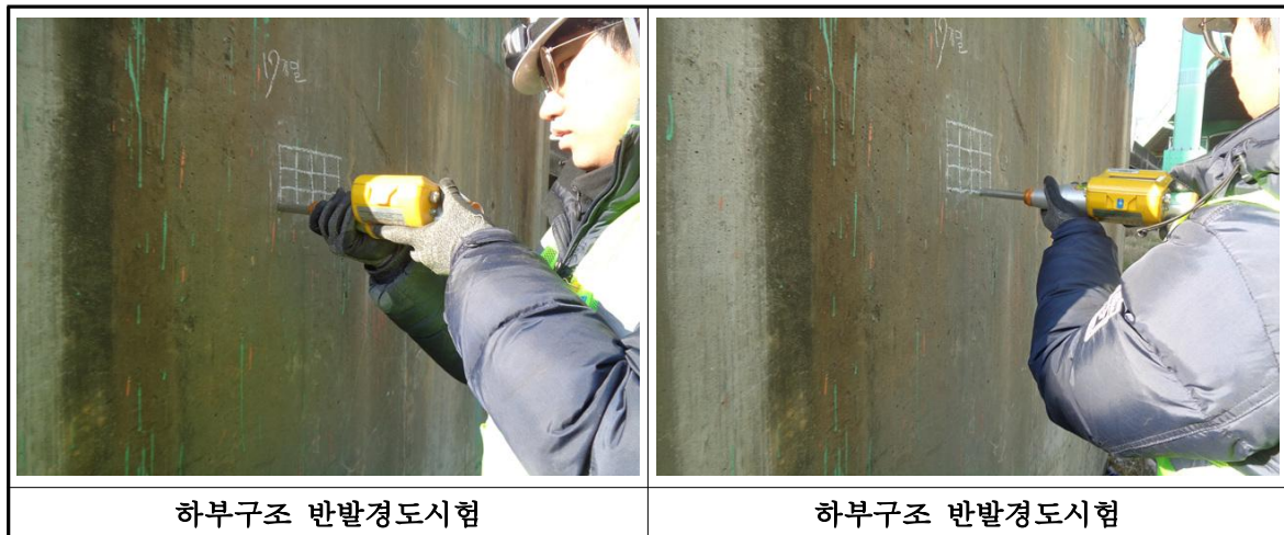
【그림 II-4.3.25】 반발경도 시험 전경
